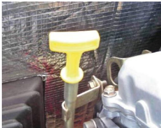
Рисунок 4.2 – Масляный щуп, модель 10кВт
