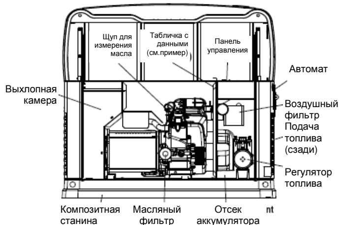
Рисунок 1.3 – 12, 14, 16, 17 и 20кВт, двухцилиндровый V-образный двигатель GT-990/GT-999 (со съемной дверцей)
