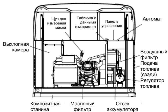
Рисунок 1.2 – 10кВт, двухцилиндровый V-образный двигатель GT-530 (со съемной дверцей)
