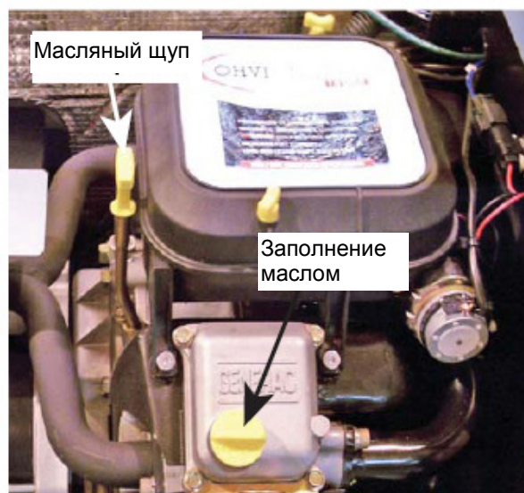
Рисунок 4.3 — Масляный щуп и заполнение, модели 12, 14, 16, 17 и 20кВт
