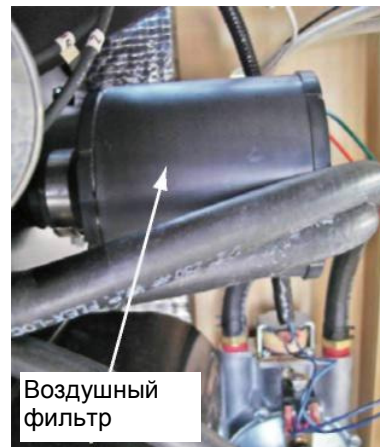
Рисунок 4.6 — Воздухоочиститель двигателя на модели 10кВт
