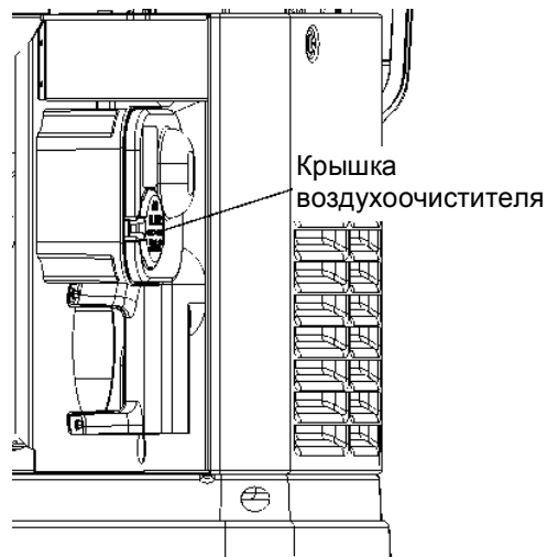
Рисунок 4.7 — Расположение воздухоочистителя на модели 8кВт
