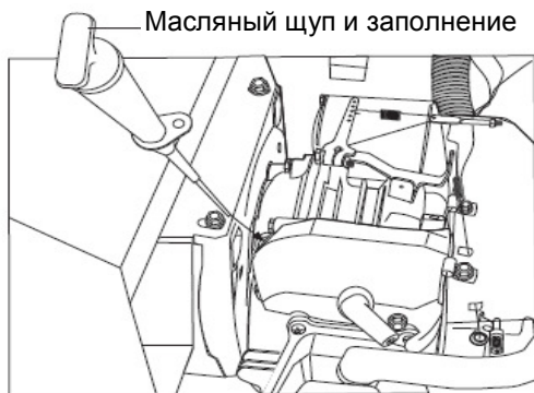
Рисунок 4.1 — Масляный щуп и заполнение, модель 8кВт
