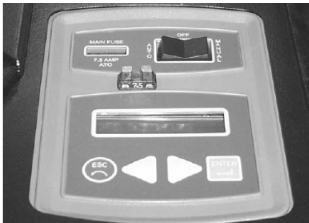
Рисунок 1. Снять предохранитель 7,5 А
