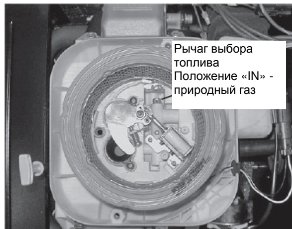
Рисунок 1. 10 и 13 кВт, GT-990 (Крышка воздушной коробки снята)
