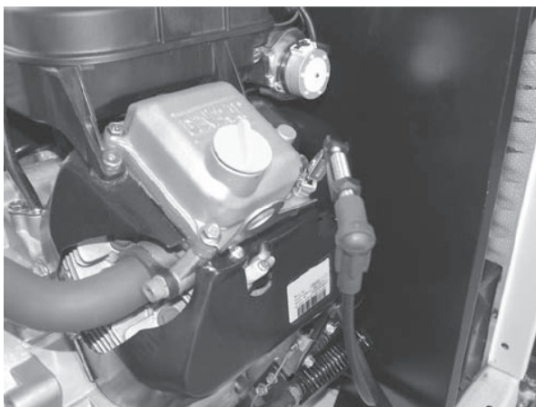
Рисунок 20. Проверка наличия искры зажигания
