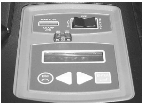
Рисунок 22. Снять предохранитель 7,5А
